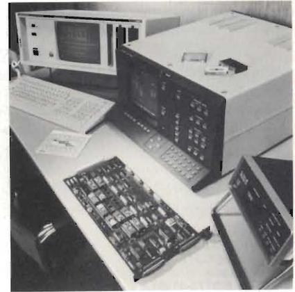
d'interfacciamento IEEE 488 (IEC 625) parallelo e RS232 (V24) seriale per la famiglia di analizzatori logici PM 3551A. Entrambe le schede d'interfaccia possono supportare fino a quattro moduli disassemblatori ed un'opzione di memoria non volatile, che permette di registrare fino a quattro programmazioni dello strumento.
