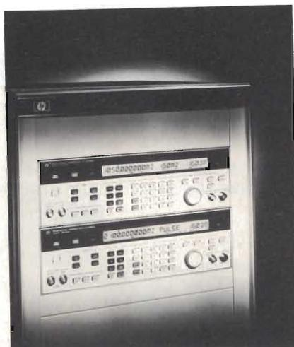
sentano un rumore di fase in banda singola laterale minore di -139 dB relativamente alla portante (dBc) a 20 kHz da un portante di 1 GHz, e mantengono i livelli dei segnali spuri al di sotto dei -100 dBc. Queste caratteristiche sono ottenute grazie all'impiego di oscillatori SAW con elevatissimi fattori di merito (Q).
