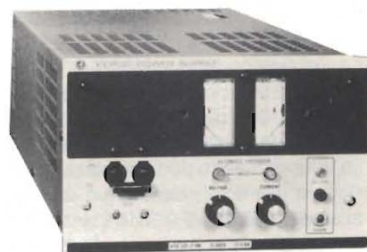
Come tutti i Power Manager Kepco, il nuovo modello ATE 325-0.8M offre un controllo esterno completo sia su tensione, sia su corrente, con crossover automatico. È programmabile tramite la sua completa scala di tensione e corrente sia localmente attraverso reostati su pannello frontale, sia da remoto attraverso un amplificatore a guadagno fisso in scala da un ingresso di 10 V alla tensione considerata. È possibile un input digitale via bus IEEE-488 con un programmatore di interfaccia digitale.
