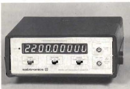
ha un display con LED da 12 mm a 7 segmenti, 3 portate con punto decimale automatico e 3 cadenze di campionatura. La sensibilità è di 100 mV RMS e c'è pure la possibilità di fissare la lettura sul display. Lo strumento ha pure incluso un circuito per la ricarica di batterie al Nichel Cadmio. Le opzioni prevedono TCXO, una sonda passa basso, antenna per RF.
